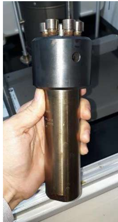
Figura 1. Reactor utilizado para ensayos de HTC
