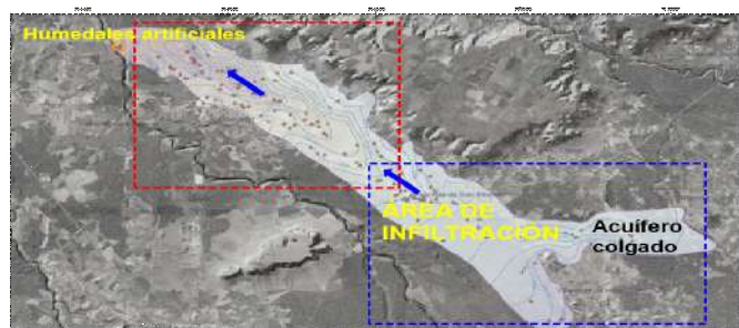
Figura 1. Sistemas MAR en el acuífero Los Arenales (a) y esquema hidráulico del sistema de Pedrajas- Alcazarén sobre una cartografía híbrida (b).
