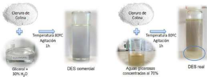
Figura 1. Aspecto del DES comercial y DES real obtenido en laboratorio.
