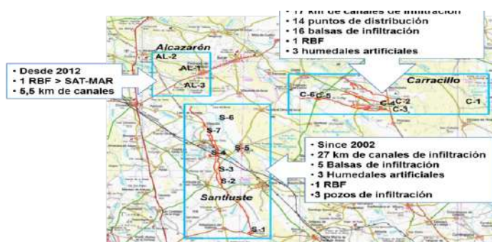
Figura 1. Sistemas MAR en el acuífero Los Arenales (a) y esquema hidráulico del sistema de Pedrajas- Alcazarén sobre una cartografía híbrida (b).
